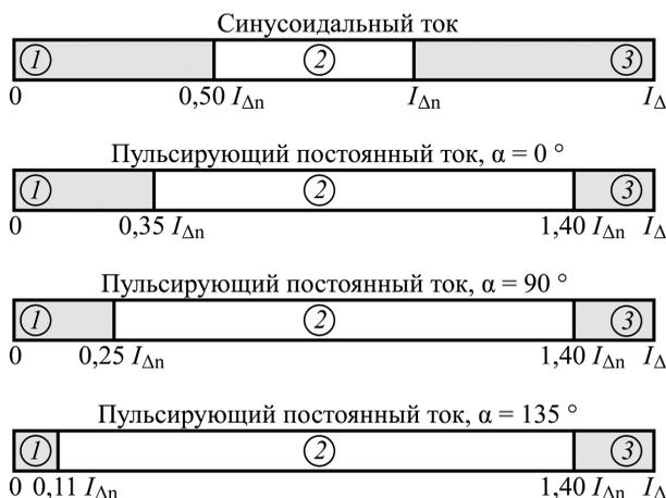
Рис. Зоны дифференциальных токов для УДТ, имеющих номинальный отключающий дифференциальный ток более 10 мА:
