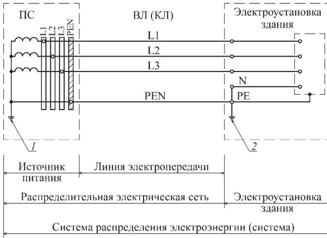
1 – заземляющее устройство источника питания; 2 – заземляющее устройство электроустановки здания; ПС – трансформаторная подстанция; ВЛ – воздушная линия электропередачи; КЛ – кабельная линия электропередачи
